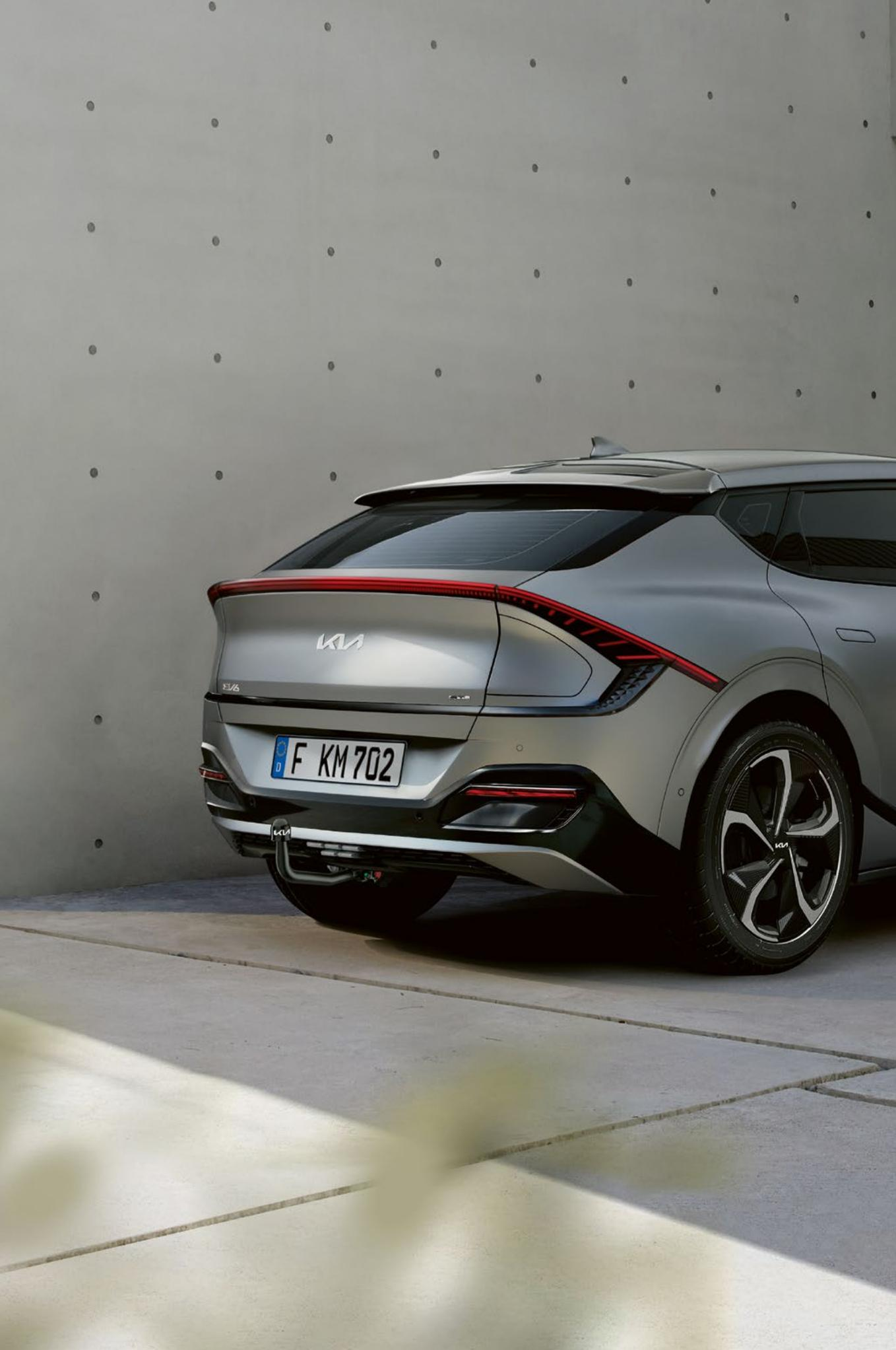
**Gancio di traino estraibile.** Se si ha un carico elevato a rimorchio, questo gancio di traino in acciaio di alta qualità e anticorrosione è l'ideale per un trasporto efficiente. Con il sistema di bloccaggio a 3 sfere è possibile rimuoverlo in modo semplice, sicuro e veloce. Vi preghiamo di informarvi presso il vostro rivenditore sul carico massimo trainabile per il vostro veicolo.
