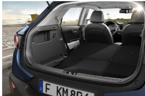
**Piano di carico regolabile.** Posizionate il piano di carico più in alto per essere a livello dei sedili posteriori ripiegati (a sinistra) oppure più in basso per sistemare oggetti alti (a destra). Nota: nelle versioni Mild Hybrid il piano è sempre posizionato in basso.
