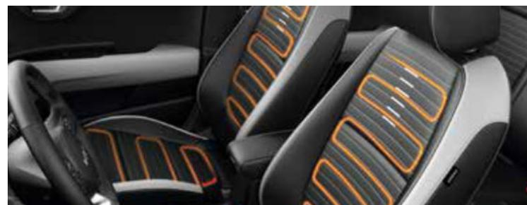
**Sedili anteriori riscaldabili.** Con tre livelli di calore regolabili, i sedili anteriori e gli schienali riscaldabili aumentano rapidamente di temperatura per poi stabilizzarsi non appena raggiunto il valore desiderato. Un meccanismo che garantisce comfort e sicurezza totale.
