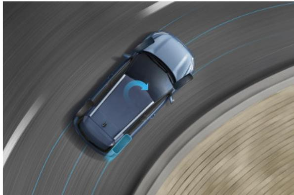
**Controllo del freno in curva (CBC).** Concepito per aiutarvi a restare in carreggiata in fase di svolta, il sistema CBC imprime alle singole ruote una forza frenante asimmetrica in fase di rallentamento in curva che contrasta potenziali perdite di trazione incrementando notevolmente la sicurezza.
