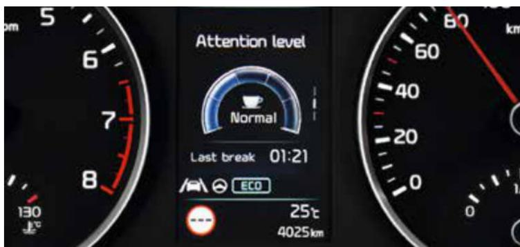
**Sistema di rilevamento della stanchezza (DAW).** Per far sì che il conducente non guidi in modo distratto o quando è troppo stanco, il sistema DAW monitora alcuni input del guidatore e del veicolo. Se rileva un'attenzione ridotta, emette un segnale acustico e visualizza un allarme nel quadro strumenti Supervision.
