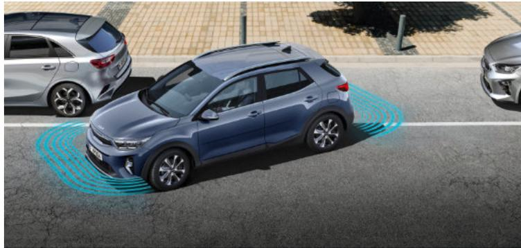
**Sensori di parcheggio anteriore/posteriore (PDW) con pulsante di attivazione/disattivazione.** Questo sistema, ideale per parcheggiare in modo agevole, si avvale di sensori a ultrasuoni inseriti sui paraurti per segnalare se sono presenti ostacoli davanti o dietro quando ci si appresta a entrare in un posteggio. I sensori possono essere accesi o spenti.
