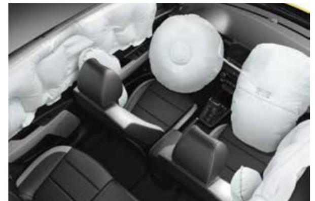
**6 airbags.** I dispositivi di protezione comprendono airbag frontali per il conducente e il passeggero anteriore, due airbag laterali e due airbag a tendina lungo tutto l'abitacolo.
