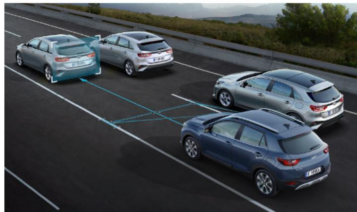
**Assistente al mantenimento della corsia (LKA).** Il sistema utilizza la telecamera e i sensori radar per mantenere una distanza di sicurezza dal veicolo che vi precede e segue la segnaletica orizzontale per mantenere la vostra vettura al centro della corsia.
