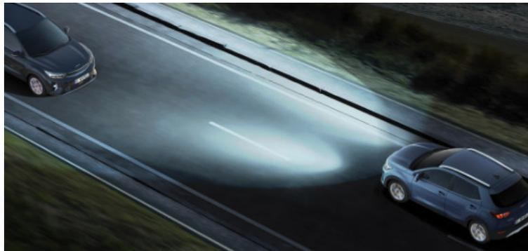
**Assistente abbaglianti (HBA).** Reagendo automaticamente alla luminosità dei fari degli altri veicoli e alle condizioni della strada, il sistema HBA spegne temporaneamente gli abbaglianti per non disturbare gli altri conducenti.
