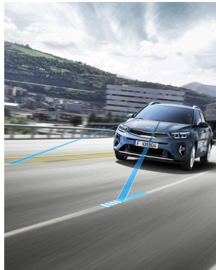
**Assistente al mantenimento della corsia (LKA).** Quando iniziate a uscire dalla vostra corsia, il sistema LKA vi avverte e corregge la vostra direzione per mantenervi in carreggiata.
