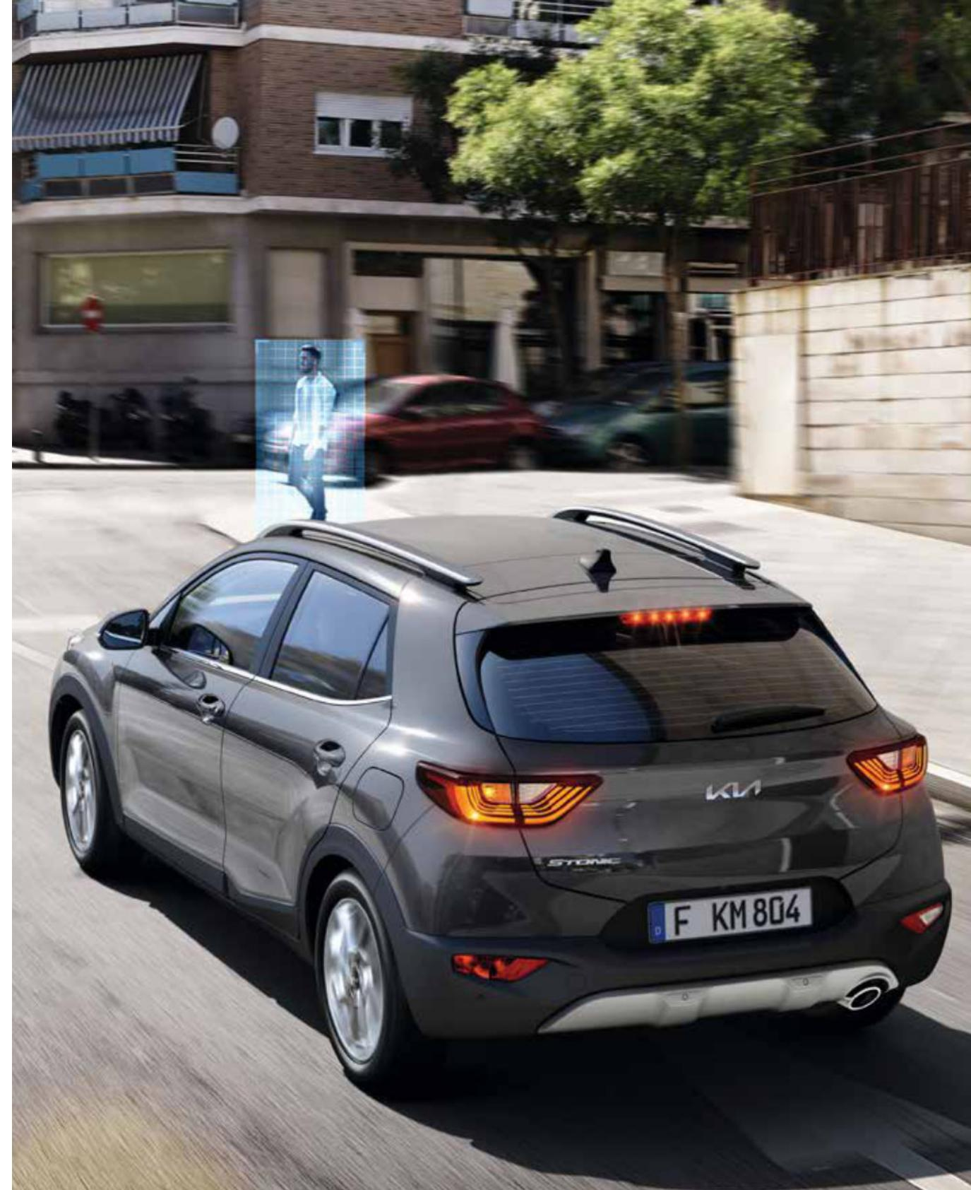
**Assistente autonomo alla frenata d'emergenza (FCA).** Unendo i dati dei radar e della telecamera, il sistema FCA attiva i freni quando rileva una frenata improvvisa da un veicolo che vi precede e può arrestare completamente la vettura a velocità fino a 60 km/h. Se il sistema individua la presenza di un pedone o un ciclista davanti alla vettura, vi avverte. Se non reagite, frena al posto vostro per evitare una potenziale collisione o ridurre l'impatto.
