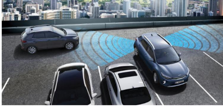
**Avviso di traffico trasversale (RCCW) e Assistente di traffico trasversale (RCCA).** Quando dovete uscire da un posteggio o da un vialetto, il sistema RCCW basato su radar vi segnala l'eventuale presenza di traffico trasversale nella corsia in cui sta entrando il veicolo. Se un veicolo sta incrociando il vostro percorso, il sistema RCCA attiva automaticamente i freni per evitare una collisione.
