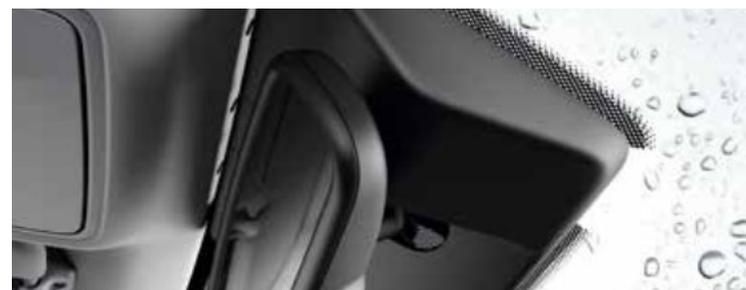
**Sensore di pioggia.** Quando rileva la presenza di gocce di pioggia sul parabrezza, il sensore di pioggia provvede ad attivare i tergicristalli.
