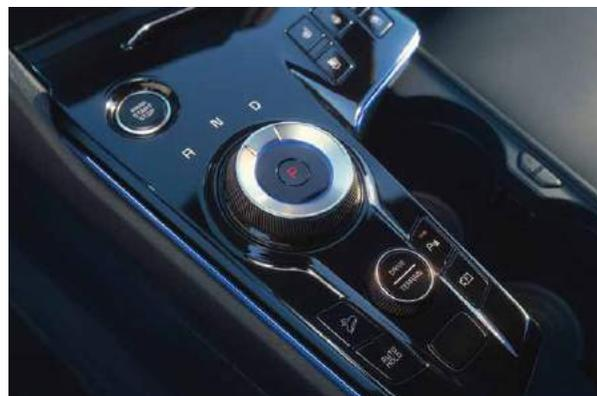
**Selettore rotativo del cambio\*.** Installato in posizione centrale e facile da raggiungere, il selettore rotativo funziona con la tecnologia shift-by-wire, permettendo di cambiare marcia senza alcuno sforzo. Altrettanto importante dal punto di vista della sicurezza, passerà automaticamente alla marcia di stazionamento «P» se il conducente dimentica di inserirla.
