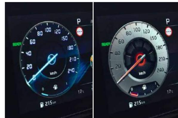
**Quadro strumenti Supervision 12.3" digitale\*.** Dotato di un display a cristalli liquidi a transistor a pellicola sottile (TFT) di ultima generazione per offrire una grafica incredibilmente precisa e chiara. A seconda del propulsore utilizzato, la nuovissima Sportage offre una gamma di modalità di guida che spazia dalla modalità Eco alla modalità Sport.
