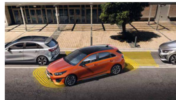
**Assistenza al parcheggio automatico (SPA).** L'assistente intelligente al parcheggio rende il parcheggio un gioco da ragazzi. Esso utilizza sensori anteriori, laterali e posteriori per assistervi nel parcheggio parallelo, angolare e perpendicolare. Tutto quello che dovete fare è gestire il freno, l'acceleratore e le marce. Il sistema si occupa dello sterzo. Può anche aiutarvi ad uscire da parcheggi paralleli.
