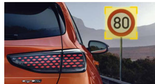
**Assistente intelligente del limite di velocità (ISLW).** L'avviso intelligente del limite di velocità fornisce tutte le informazioni necessarie per aiutarvi a non oltrepassare i limiti di velocità. Utilizzando la videocamera sul parabrezza, legge i limiti di velocità e le restrizioni di sorpasso. Visualizza quindi le informazioni in modo chiaro su schermo e quadro di navigazione.
