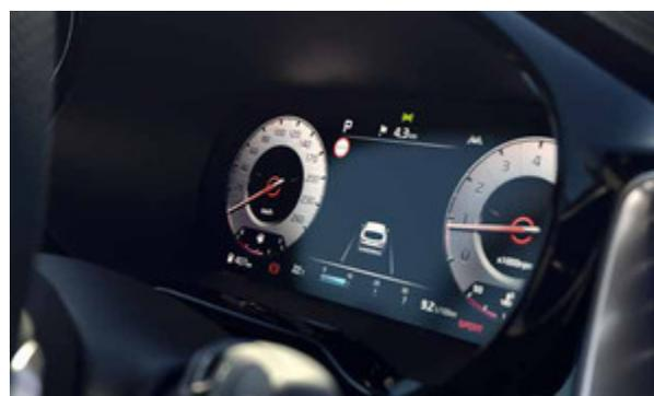
**Quadro strumenti 12.3".** Il quadro strumenti completamente digitale è dotato di un display ad alta definizione da 12,3" con quattro diversi temi e una grafica dedicata all'ibrido plug-in. Monitorate le informazioni diagnostiche costantemente aggiornate sul veicolo e sul viaggio, come il livello di carburante e la pressione degli pneumatici. Se state guidando la Ceed Sportswagon PHEV potete monitorare la modalità di guida corrente, la carica della batteria e l'autonomia residua.
