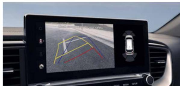
**Videocamera posteriore.** La videocamera posteriore è dotata di una funzionalità migliorata per garantire la vostra sicurezza quando parcheggiate in retromarcia. È ora possibile scegliere tra una varietà di viste della videocamera con linee guida dinamiche sullo schermo per aiutarvi a posizionarvi nel parcheggio. Inoltre, ora è possibile attivare il monitor in modo da poter vedere il traffico in avvicinamento.
