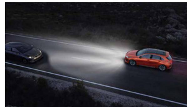
**Assistente abbaglianti (HBA).** Quando la videocamera sul parabrezza rileva i fari di un veicolo che si avvicina di notte in direzione opposta, il sistema passa automaticamente agli anabbaglianti per evitare di abbagliare gli altri conducenti. Dopo che l'auto è passata, gli abbaglianti si riaccendono automaticamente.
