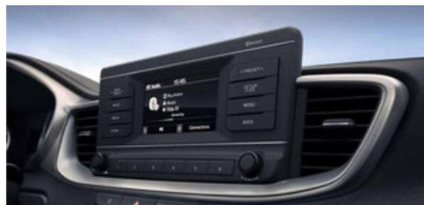
**Sistema audio 5".** Il sistema audio da 5" con RDS e DAB è caratterizzato da uno schermo mono TFT-LCD. Oltre alla radio, offre connettività con altri dispositivi portatili, come uno smartphone, utilizzando le porte USB. Offre inoltre streaming audio via Bluetooth senza togliere le mani dal volante.
