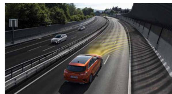
**Tempomat e assistente curva basato sulla navigazione (NSCC).** Usata in combinazione con HDA, la funzione curva utilizza i dati di navigazione per riconoscere una curva imminente sulla strada, riducendo la velocità di crociera e, superata la curva, riporta la velocità al livello preimpostato se le condizioni lo consentono.
