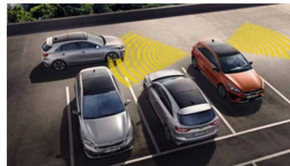
**Avviso di traffico trasversale in retromarcia (RCCA).** Quando si parcheggia in parallelo o si esce in retromarcia da un parcheggio o da un vialetto, il sistema anti-collisione al traffico trasversale in retromarcia basato su radar avverte di eventuale traffico in avvicinamento nella vostra direzione e frena per evitare una collisione.
