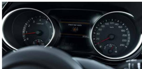
**Supervision Cluster 4,2".** Con un display LCD, questo quadro di supervisione personalizzabile e dal design intelligente visualizza la temperatura esterna e i dati di viaggio del veicolo, e consente di regolare le impostazioni.
