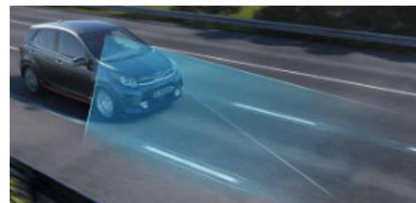
**Assistente di mantenimento della corsia (LFA).** Il sistema LFA rappresenta un importante passo avanti verso la guida semiautonomo. Utilizzando i dati forniti dalla telecamera, il veicolo è in grado di rilevare la segnaletica orizzontale e di imprimere leggere manovre correttive per mantenervi al centro della corsia. Un dispositivo utile soprattutto quando si guida in autostrada!
