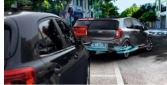
**Sensori di assistenza al parcheggio posteriore (PDW).** Questo sistema, ideale per parcheggiare in modo agevole, si avvale di sensori a ultrasuoni inseriti sul paraurti posteriore per segnalare se sono presenti ostacoli davanti o dietro quando ci si appresta a entrare in un posteggio.
