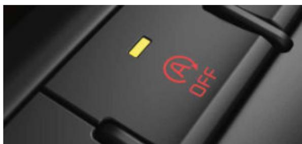
**Start-Stop-System (ISG).** La tecnologia ISG è presente come dotazione standard su tutti i modelli Picanto ed è concepita per ridurre i consumi di carburante spegnendo il motore a veicolo fermo.
