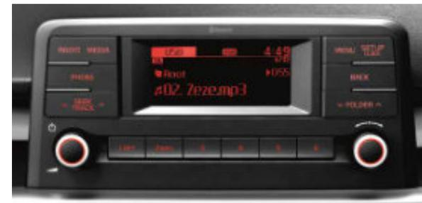
**Impianto audio.** Il compatto impianto audio 3.0 opzionale con 5 altoparlanti, RDS e DAB include uno schermo TFT-LCD piatto monocromatico. Oltre alla radio, offre la possibilità di collegare dispositivi portatili tramite l'ingresso USB.
