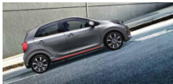
**Assistente antiarretramento in salita (HAC).** Quando siete fermi o in coda, l'HAC vi evita di indietreggiare. Il sistema frena leggermente dal momento in cui sollevate il piede dal pedale del freno, dandovi tempo per spostarlo tranquillamente sull'acceleratore.
