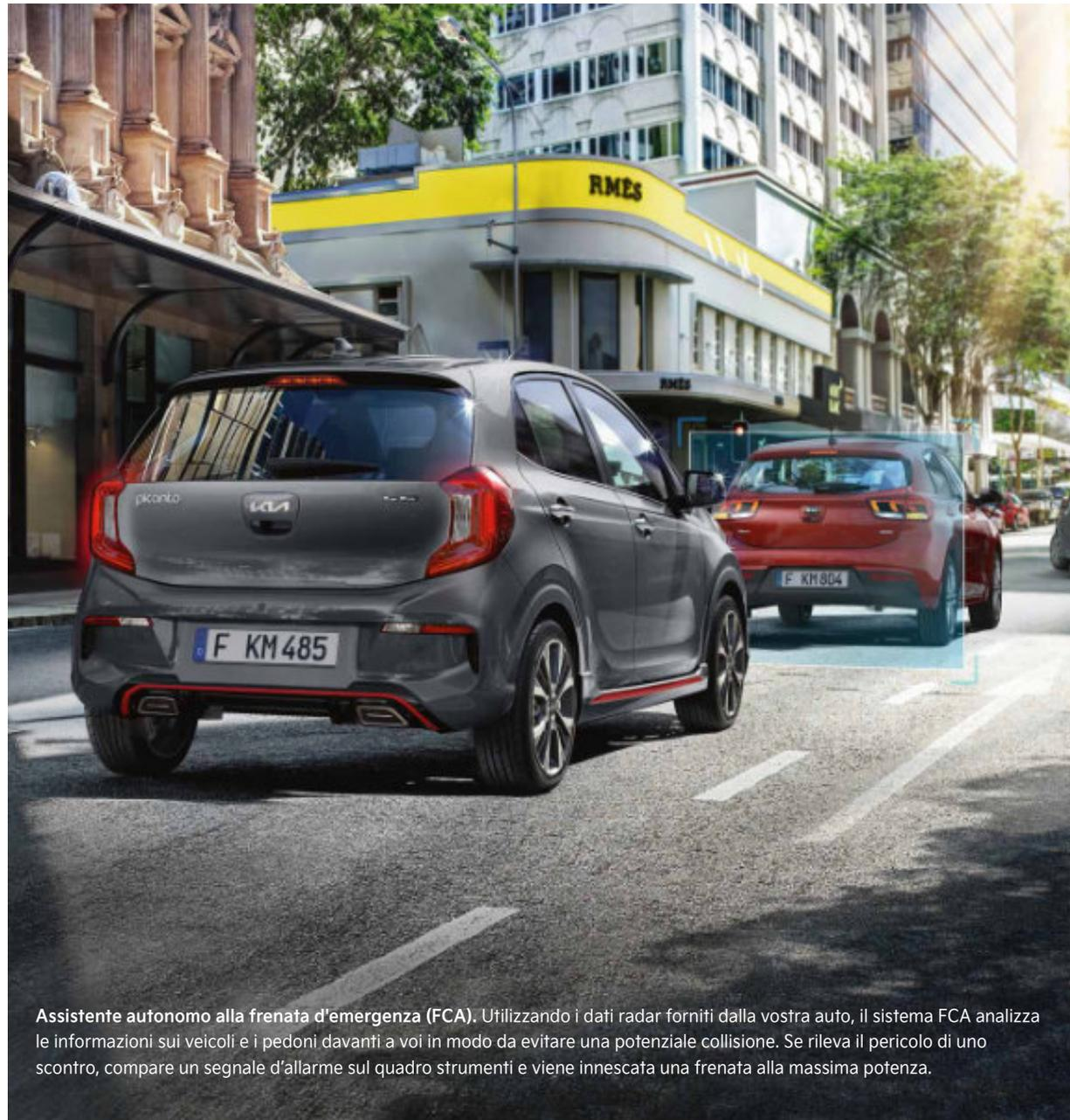
**Assistente autonomo alla frenata d'emergenza (FCA).** Utilizzando i dati radar forniti dalla vostra auto, il sistema FCA analizza le informazioni sui veicoli e i pedoni davanti a voi in modo da evitare una potenziale collisione. Se rileva il pericolo di uno scontro, compare un segnale d'allarme sul quadro strumenti e viene innescata una frenata alla massima potenza.
