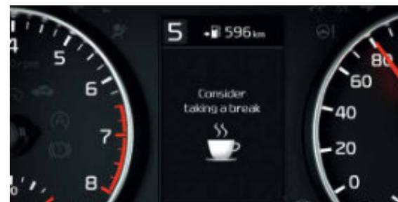
**Sistema di rilevamento della stanchezza (DWA)\*.** Il sistema DAW rileva se state perdendo concentrazione monitorando l'uso del volante e degli indicatori di direzione. Se per esempio mostrate segnali di sonnolenza, il DAW vi invita a prendervi una pausa emettendo un segnale acustico e visualizzando l'icona della tazza di caffè sul quadro strumenti.
