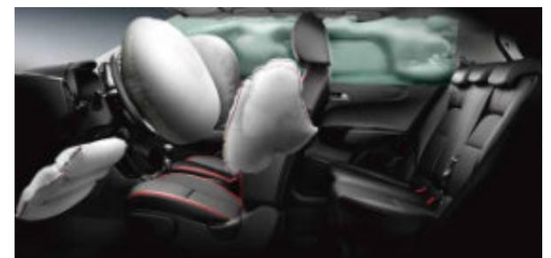
**Airbag frontali, laterali, a tendina e per le ginocchia.** Per proteggere ulteriormente le persone a bordo e ridurre possibilmente le conseguenze di un'eventuale collisione, la Picanto presenta airbag per il conducente e il passeggero anteriore, due airbag laterali anteriori, due airbag laterali a tendina e un airbag opzionale per le ginocchia del conducente.
