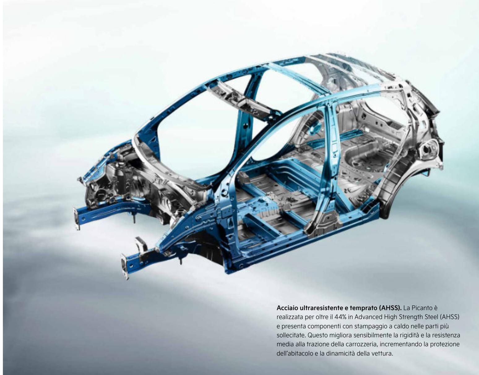
**Acciaio ultraresistente e temprato (AHSS).** La Picanto è realizzata per oltre il 44% in Advanced High Strength Steel (AHSS) e presenta componenti con stampaggio a caldo nelle parti più sollecitate. Questo migliora sensibilmente la rigidità e la resistenza media alla trazione della carrozzeria, incrementando la protezione dell'abitacolo e la dinamicità della vettura.
