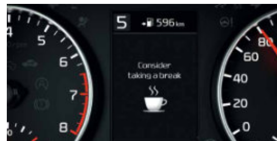
Müdigkeitserkennung (DAW)*. Die Müdigkeitserkennung (Driver Attention Warning, DAW) erkennt, wenn Ihre Konzentration nachlässt, indem sie Lenkrad und Blinker überwacht. Wenn Sie beispielsweise Anzeichen von Müdigkeit zeigen, fordert das System Sie anhand eines akustischen Warnsignals dazu auf, eine Pause einzulegen und aktiviert auf der Instrumentenanzeige eine Kontroll-Leuchte in Form einer Kaffeetasse.
