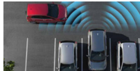
Rückfahr-Querverkehrwarner (RCCA). Um das Rückwärtsfahren sicherer zu machen - insbesondere beim rückwärts Ausparken bei eingeschränkter Sicht - reduziert der Querverkehrwarner das Unfallrisiko durch den Einsatz von Radarsensoren zur Überwachung des Verkehrs hinter Ihnen. Wenn sich ein Fahrzeug seitlich nähert, warnt Sie der Querverkehrwarner mit einem Warnsymbol auf den Seitenspiegeln, einem akustischen Warnsignal, einer Warnung auf der Instrumentenanzeige oder auf dem zentralen 8-Zoll-Display und betätigt gegebenenfalls die Bremsen.*
