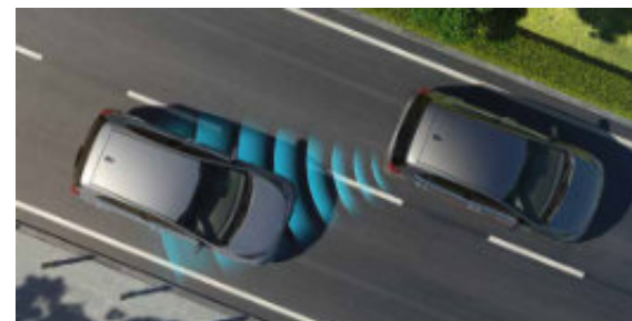
Totwinkelwarner (BCW) und Totwinkelassistent (BCA). Wenn Sie die Spur wechseln wollen, erkennt der Totwinkelwarner (Blind-Spot Collision Warning, BCW) Fahrzeuge, die sich im toten Winkel befinden, und warnt Sie mit einem Warnsymbol im Seitenspiegel sowie einem akustischen Warnsignal. Wenn Ihr Fahrzeug mit einem AMT-Getriebe ausgestattet ist und Sie beginnen, die Spur zu wechseln, während sich ein Fahrzeug im toten Winkel befindet, aktiviert der aktive Totwinkelassistent (Blind-Spot Collision Avoidance Assist, BCA) des Kia Picanto die Bremsen und blendet gleichzeitig Warnsymbole in den Seiten- und Rückspiegeln ein, während er ein akustisches Warnsignal abgibt.
