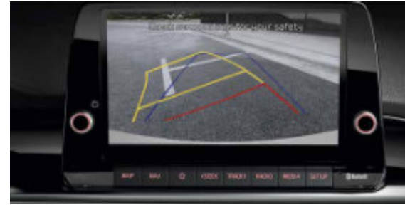
Rückfahrkamera. Wenn Sie rückwärts in eine Parklücke einparken, projiziert die wasserdichte Rückfahrkamera ein Bild mit dynamischen Führungslinien, die das Einparken vereinfachen, auf das schwebende 8-Zoll-Display.
