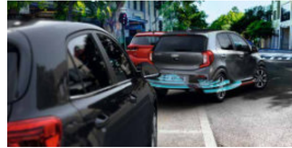
Parkensensoren hinten (PDW). Ideal für sicheres Einparken: Die PDW-Technologie warnt beim Einparken in eine Parklücke mit Ultraschallsensoren an der hinteren Stossstange vor Hindernissen vor oder hinter dem Fahrzeug.
