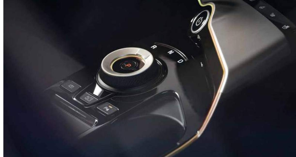
**Tecnologia Shift by Wire.** Per passare da retromarcia a marcia avanti e folle è sufficiente frenare e ruotare verso destra o verso sinistra la manopola del sistema Shift by Wire. La posizione «P» mette la Kia EV6 in modalità di parcheggio.
