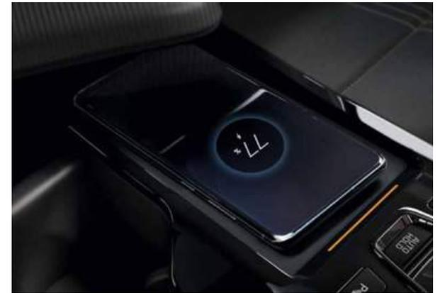
**Stazione di ricarica induttiva.** La stazione di ricarica integrata nella consolle centrale anteriore consente di ricaricare in modalità wireless tutti gli smartphone compatibili. Il caricatore da 15 W garantisce una ricarica rapida.
