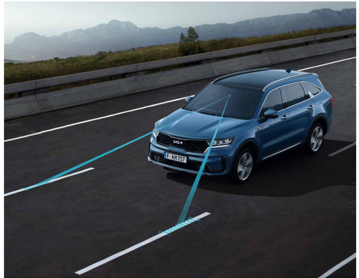
**Spurhalteassistent.** Der Spurhalteassistent überwacht mithilfe einer Frontkamera die Strassenmarkierungen. Wenn der Fahrer unbeabsichtigt die Fahrspur verlässt, löst das System einen Alarm aus und bringt den Wagen durch einen aktiven Lenkeingriff zurück in die Spur.
