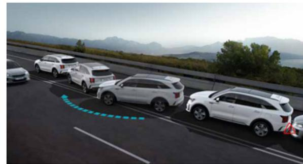
**Multikollisionsbremse.** Löst der Airbag aufgrund einer Primärkollision aus, wird sofort ein Signal an die elektronische Stabilitätskontrolle gesendet, damit diese das Fahrzeug abbremst. Das Multikollisionsbremssystem leitet den Bremsvorgang ein, um weitere Kollisionen zu verhindern oder deren Auswirkungen abzumildern.
