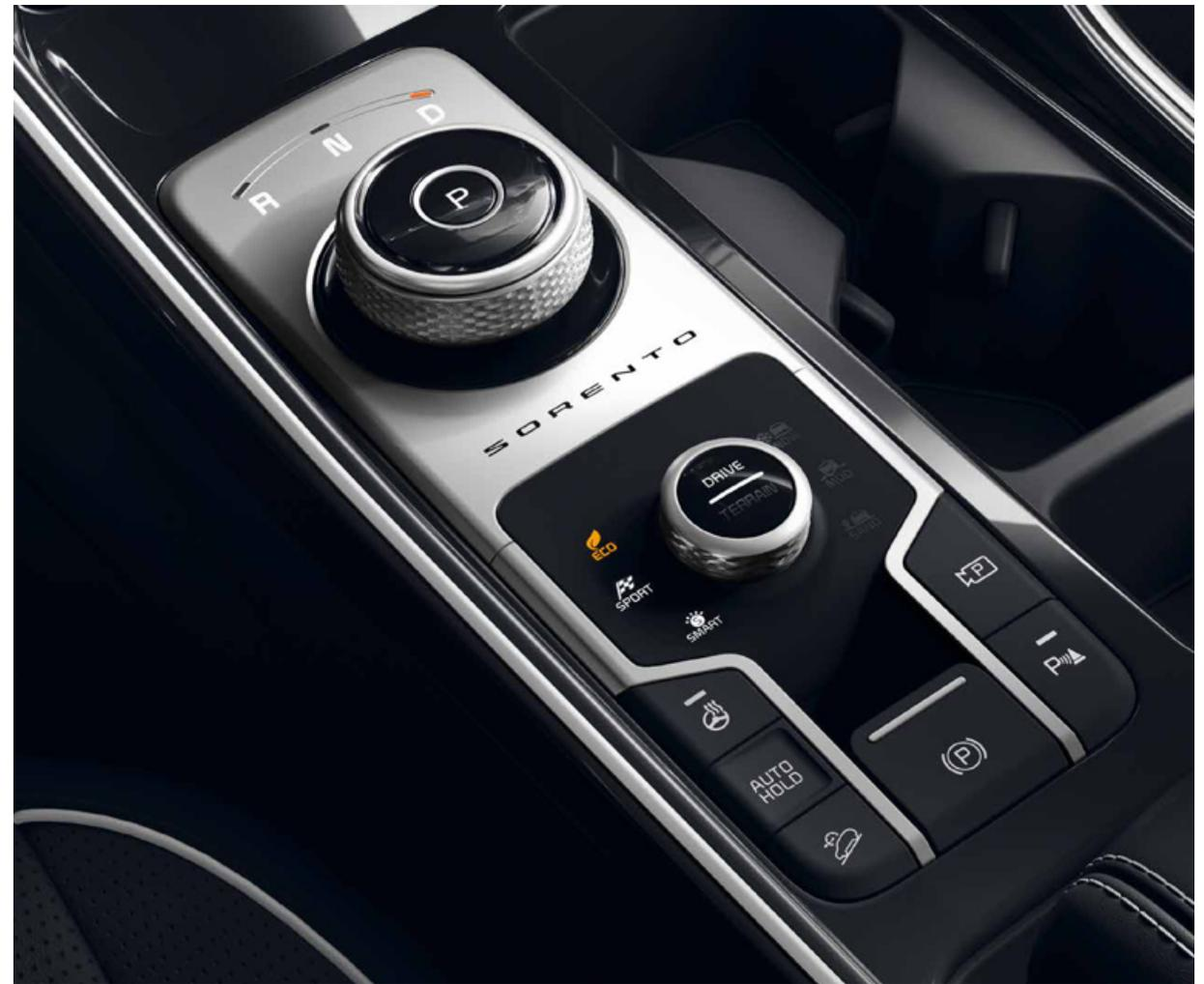
**Gangwahl-Drehschalter.** Der Gangwahl-Drehschalter liegt zentral und ist gut erreichbar. Er basiert auf der Shift-by-Wire-Technologie und erlaubt geschmeidige Schaltvorgänge. Sicher ist sicher: Der Gangwahl-Drehschalter schaltet automatisch in «P», wenn der Fahrer dies vergisst.
