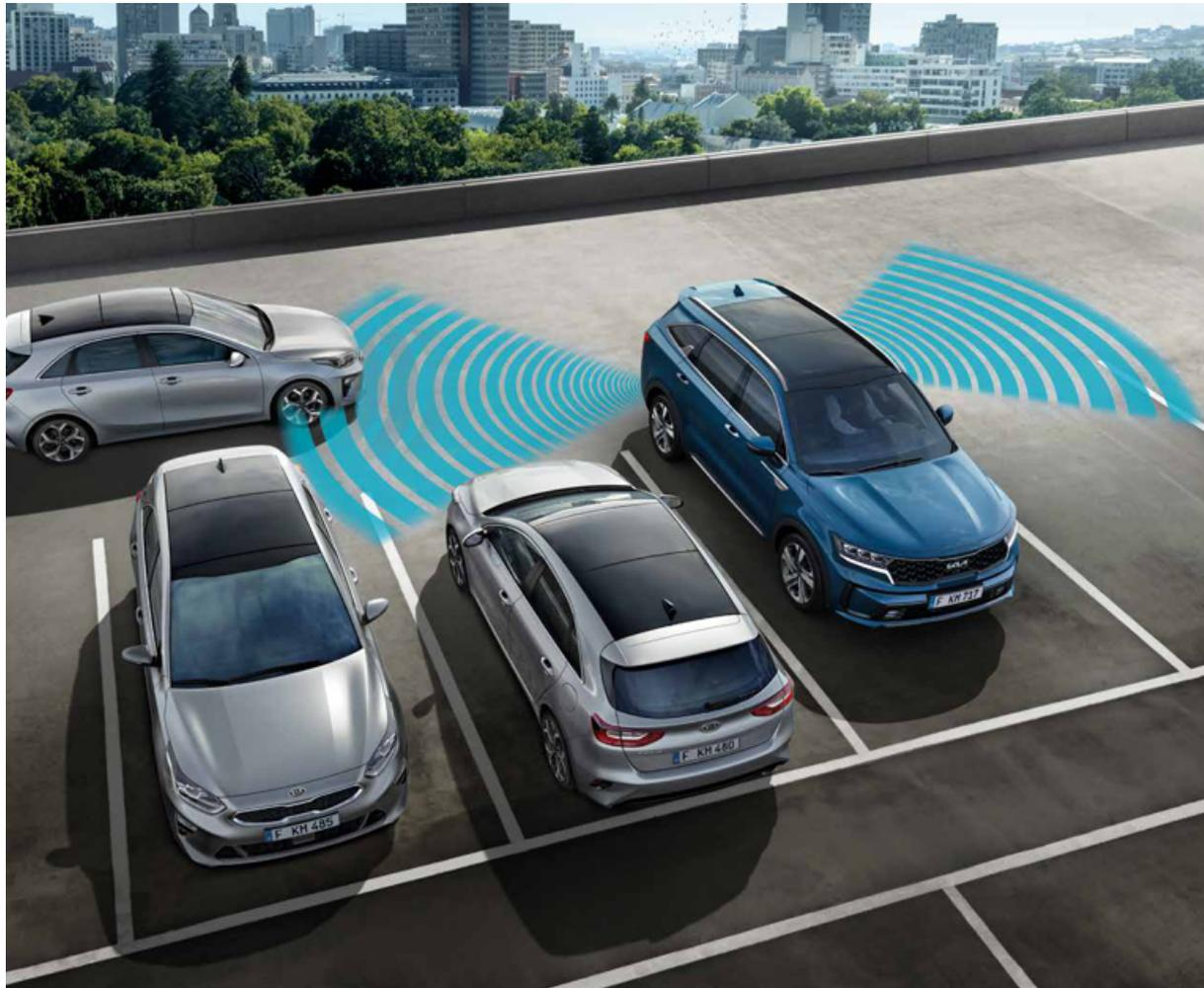
**Rückfahr-Querverkehrswarner\*.** Für ein sichereres Zurücksetzen - insbesondere aus einer Parklücke mit eingeschränkter Sicht - gibt der Rückfahr-Querverkehrswarner visuelle/akustische Alarmsignale aus und unterstützt beim Bremsen, wenn einer der Radarsensoren am Heck ein Fahrzeug erkennt, das sich von links oder rechts nähert. (Wählt der Fahrer im Menü «Nur Warnung», gibt das System nur akustische und visuelle Warnungen aus, greift jedoch nicht in den Bremsvorgang ein.)
