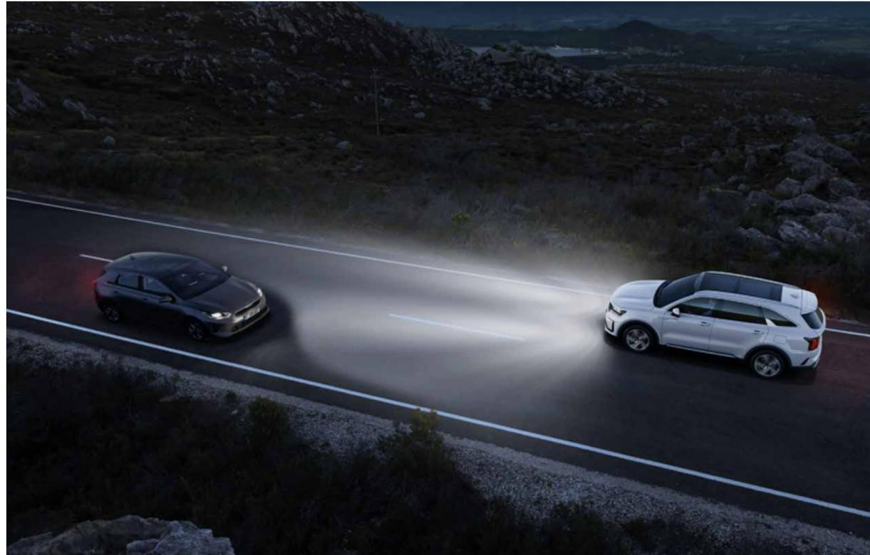
**Fernlichtassistent.** Wenn es die Bedingungen erlauben, wird der Kia Sorento automatisch das Fernlicht einschalten. Erkennt die Kamera in der Windschutzscheibe bei Dunkelheit die Scheinwerfer eines entgegenkommenden Fahrzeugs, schaltet der Fernlichtassistent automatisch auf Abblendlicht um, damit der andere Fahrer nicht geblendet wird.
