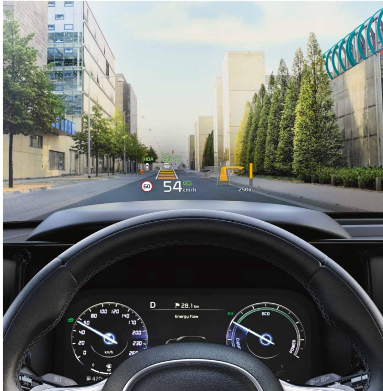
**Head-up display\***. Damit Sie die Strasse nicht aus den Augen verlieren, projiziert das Head-up Display die Geschwindigkeit und andere Fahrzeugdaten an die Windschutzscheibe, direkt in Ihre Sichtachse.
