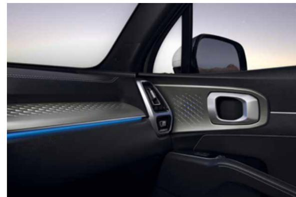
**Ambientebeleuchtung\***. Für die perfekte Atmosphäre befinden sich in den Türen und unter dem Armaturenbrett sogenannte «Mood Lights». Damit lässt sich der Innenraum in einer der sieben voreingestellten Grundfarben bzw. einer von 64 weiteren Farben auf die von Ihnen bevorzugte Stimmung einstellen. So wird jede Fahrt so entspannend oder aufregend wie Sie es wünschen.
