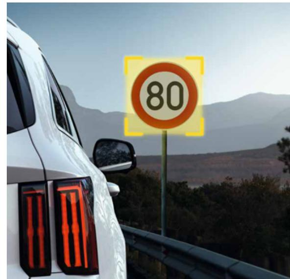
**Anzeige Tempolimit.** Wenn Sie die Anzeige Tempolimit aktivieren, nutzt das System die Kamera, um die Verkehrszeichen mit Geschwindigkeitsbegrenzungen zu lesen. Diese werden dann neben dem Tachometer und auf dem Navigationsdisplay angezeigt. Sie können dann entscheiden, ob Sie Ihre Geschwindigkeit auf die aktuelle Höchstgeschwindigkeit einstellen möchten oder nicht.
