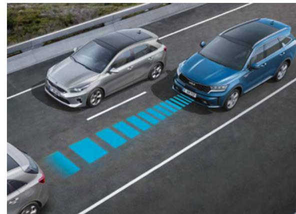
**Tempomat mit Distanzassistent.** Der Tempomat mit Distanzassistent nutzt Kamera und Radarsensoren, um die eingestellte Geschwindigkeit sowie einen Sicherheitsabstand zum vorausfahrenden Fahrzeug einzuhalten. Das System kontrolliert zudem Beschleunigungs- und Bremsvorgänge des vorausfahrenden Fahrzeugs, um sicherzustellen, dass Ihr Fahrzeug anhält, wenn das vorausfahrende Fahrzeug anhält und dass Ihr Fahrzeug anfährt, sobald sich das vorausfahrende Fahrzeug wieder in Bewegung setzt.
