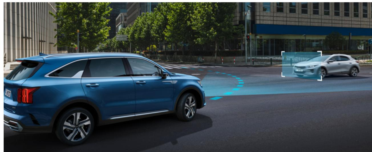
**Abbiegeassistent.** Der Abbiegeassistent arbeitet mit Radar- und Kameradaten aus Ihrem Fahrzeug. Es analysiert Informationen über andere Fahrzeuge, Fussgänger und Radfahrer, die die Strasse kreuzen, um eine potenzielle Kollision mit diesen zu verhindern. Der Abbiegeassistent dient auch dazu, beim Linksabbiegen an Kreuzungen Kollisionen zu vermeiden. Wird die Gefahr einer Kollision erkannt, zeigt die Instrumenteneinheit ein Warnsignal und die maximale Bremskraft wird ausgeübt.
