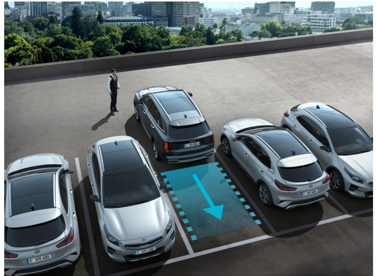
**Ferngesteuerter Parkassistent\*.** Der ferngesteuerte Parkassistent ist ein komfortables System, das dem Fahrer das Einparken oder das Verlassen einer Parklücke erleichtert, indem es das Fahrzeug automatisch einparkt oder manövriert. Ebenfalls möglich ist es, das Fahrzeug von Ausserhalb per Fernsteuerung über den Autoschlüssel vorwärts oder rückwärts zu bewegen.
