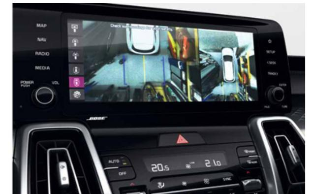
**360°-Monitor (Rundumsichtkamera)\***. Sicherheit nach allen Seiten: Dieses intuitive System kombiniert die Bilder von vier Weitwinkelkameras an Front, Heck und Seiten des Kia Sorento und präsentiert das Ergebnis auf dem Navigationsdisplay. Damit erleichtert das System das Parken sowie das Manövrieren bis zu einer Geschwindigkeit von 20 km/h.
