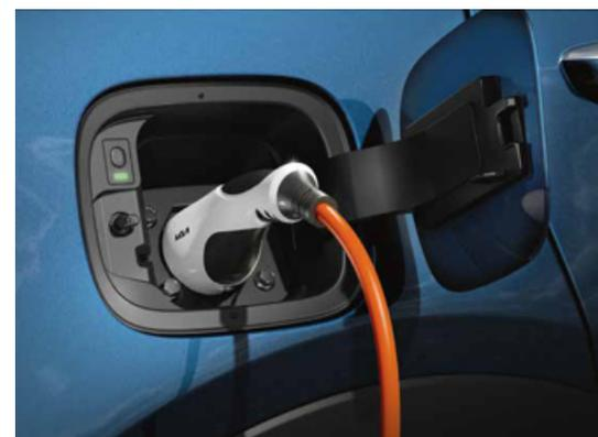
**Ladekabel mit Steuerung.** Mit dem serienmäßigen Ladekabel des Kia Sorento Plug-in-Hybrid lässt sich das Fahrzeug bequem an einem Hausanschluss laden. Für noch mehr Sicherheit lässt sich die Stromstärke über die ins Kabel integrierte Steuerung drosseln.
