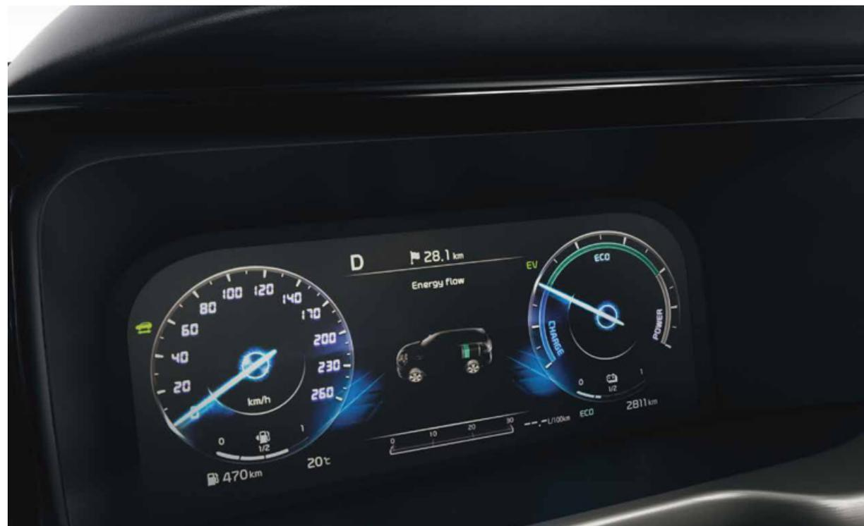
**Instrumentenanzeige "SUPERVISION".** Die ausgeklügelte, individualisierbare Supervision-Instrumenteneinheit liefert wichtige Informationen zur Fahrt und zum Fahrzeug, von der Temperatur bis zur Reifendruckwarnung. Es zeigt zudem den Status des Hybridsystems an, einschliesslich Tankfüllung, Treibstoffverbrauch, Batteriestand und -nutzung. Der hochauflösende Bildschirm bietet leicht ablesbare, vielfältige Informationen auf einen Blick.
