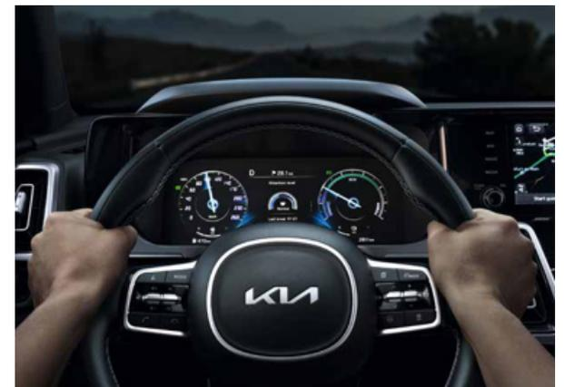
**Müdigkeitserkennung.** Das System erkennt durch die Überwachung von Lenkrad, Blinker und Beschleunigungsmustern, ob Ihre Konzentration nachlässt und warnt Sie entsprechend. Wenn beispielsweise während der Fahrt das vorausfahrende Fahrzeug wegfährt und Sie nicht aufschliessen, gibt das System eine Warnung aus. Wenn Sie Ermüdungserscheinungen zeigen, schlägt es Ihnen vor, eine Pause einzulegen.
