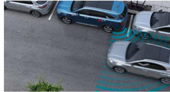
**Ausstiegsassistent\*.** Das System verhindert, dass die Hintertüren geöffnet werden, wenn das Fahrzeug eine von hinten kommende Gefahr erkennt. Ist dies der Fall, wird die elektrische Türverriegelung betätigt und ein akustischer und visueller Alarm ausgegeben.
